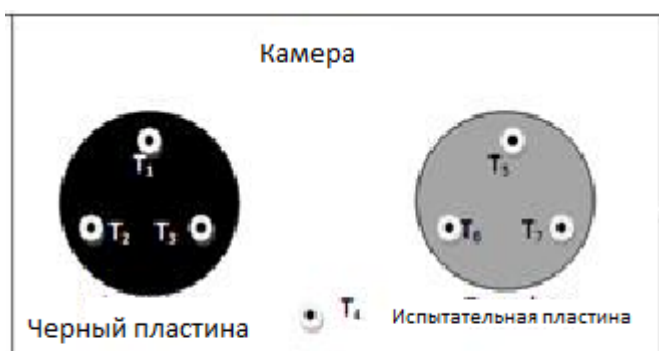
Рис.1 Поперечное сечение излучательного устройства
